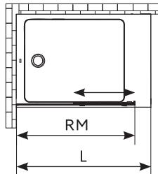
Duschabtrennung mit einem fixem Glas mit transparentem Profil auf der einen Seite und einer Schiebetür auf der anderen Seite
