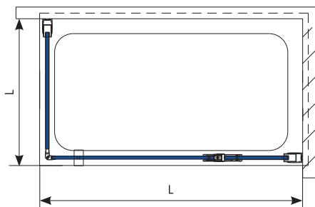
В данном случае душевое ограждение устанавливается на бортик душевого поддона или ванны, как на схематическом рисунке выше, а не на край.
