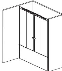
Ограждение на ванну состоит из боковых стёкол. Каждое из которых состоит из неподвижного стекла у стены с прозрачным профилем и раздвижной двери
