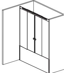
Ограждение на ванну состоит из боковых стёкол. Каждое из которых состоит из неподвижного стекла у стены с прозрачным профилем и раздвижной двери
