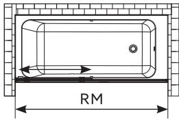
Badewannen Duschabtrennung mit einem fixem Glas mit transparentem Profil und einer Schiebetür
