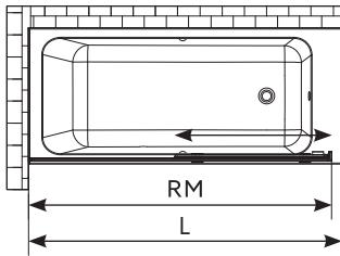
Badewannenabtrennung bestehend aus einem festen Glasteil, das mit Ausgleichsprofil an der Wand befestigt wird, und einer Schiebetür
