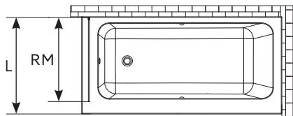
Badewannenwand, zu montieren zusammen mit Modell Silke 9B C. Bestehend aus einem Glasteil, das mit Ausgleichsprofil an der Wand befestigt wird
