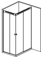
Душевое ограждение с двумя боковыми неподвижными стеклами прикрепленными к стене с помощью прозрачных профилей и две раздвижные двери
