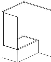
Шторка для ванны для установки с моделью Silke 9B C. Состоит из одного стекла, крепящегося к стене с помощью компенсационных профилей
